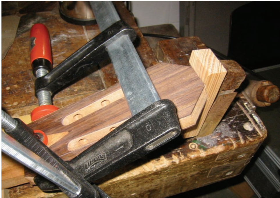
Bild 1 : Dreipunktverleimung von Hals-Kopfplatte mit verdecktem Schwalbenschwanz
