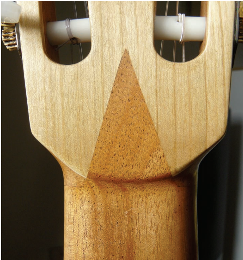
Bild 3 : Übergang Halsprofil zur Kopfplatte
