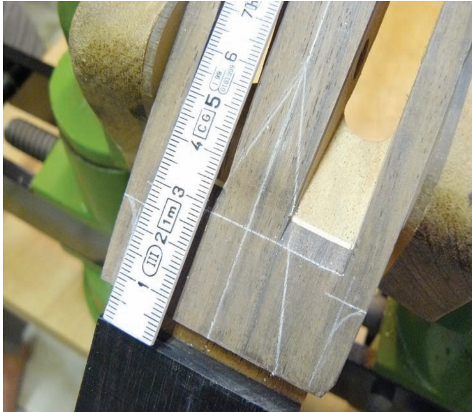
Bild 4: Abschrägung für den Saitenlauf
